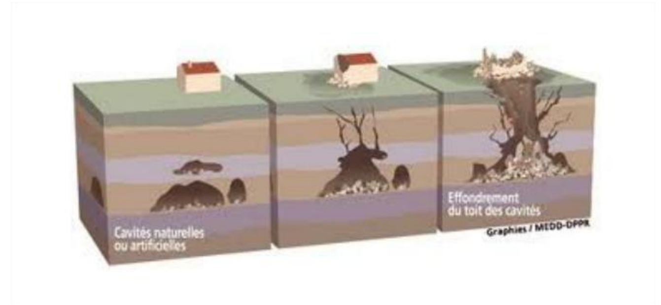
Figure 1: Effondrements de cavités souterraines
